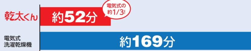
※条件：実用衣類 5kg(綿 50%、化繊 50%) / 脱水度 70% RDT-52S 標準コースで算出。リンナイ調べ
